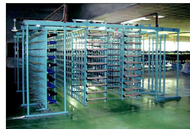
回转矩形筒子架 rewind rectangle bobbin creel
