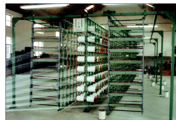
固定式筒子架 fixed creel
