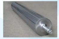
染浆联合机氧化架采用梅花辊, 可以使纱线氧化更充分,同时可减少 纱线的横 向移动,更不易粘毛羽,减 少氧化辊清洗的次数。
