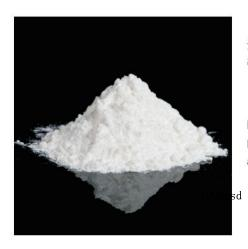
HDR-510 是一种采用氯化法工艺生产并经过特殊无机和有机处理的通用型金红石型二氧化钛颜料。该产品光泽度好、分散性良好,并具有很强的遮盖力、着色力以及良好的抗侯性。
