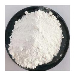
HDR-808是本品属于通用型金红石型钛白粉,经过有机表面处理,并经过硅铝氧化物包膜。本品具有优异的白度、杰出的分散性,超强的着色力,优越的耐候性和光泽度。
