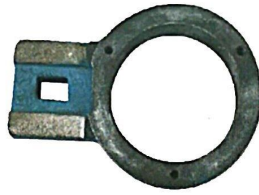
2 上铁炮轴承座 Top cone shaft pedestal
