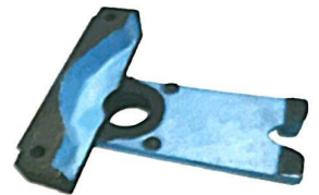
8 前滑座 Lifter slide for G.E bobbin rail
